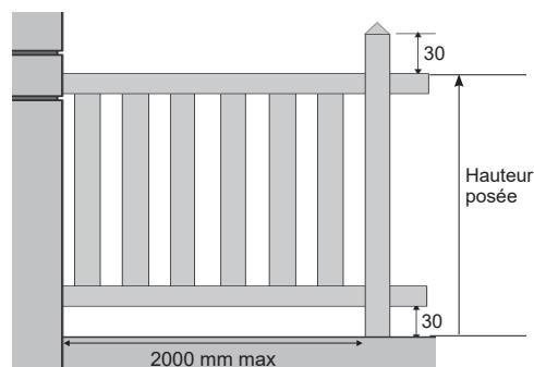
Espace entre barreaux variable suivant contraintes et règles de fabrication.
