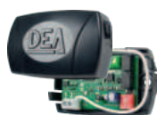
Récepteur modulaire : permet la commande d'autres motorisations (porte de garage...)
