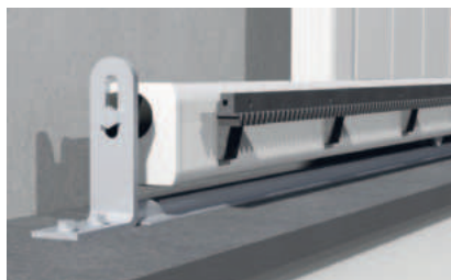
Rail inox + Butée + Roulette pour portail coulissant composée de : • chape alu (couleur portail) • galet inox + Crémaillère en nylon armé pour motorisation
